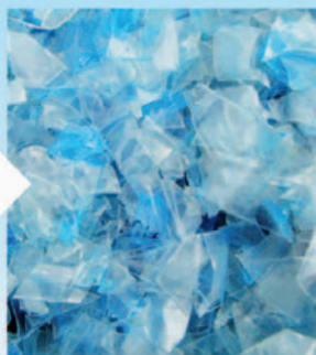
Durch standardisierte Reinigungs- und Zerkleinerungsverfahren werden sortenreine PET-Flakes gewonnen
