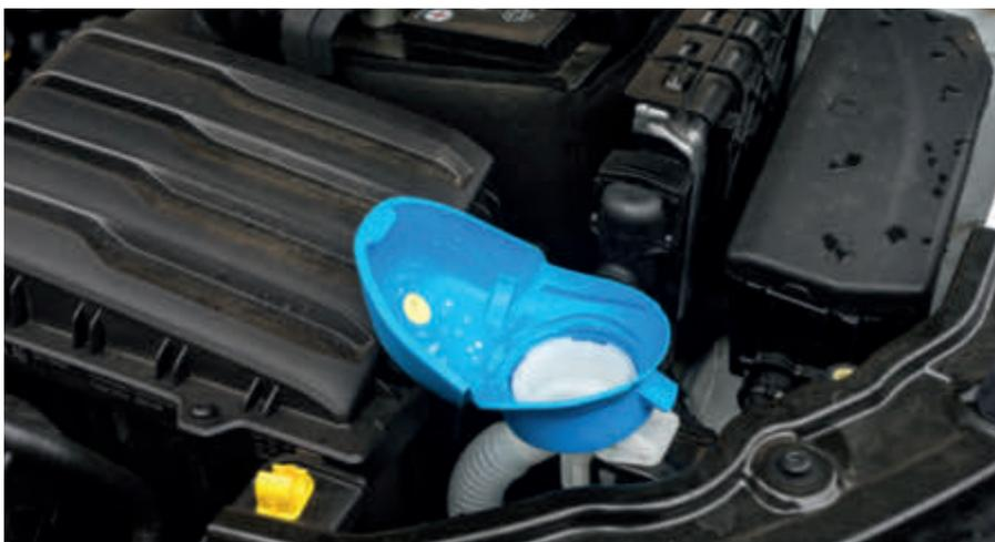
Genial einfach: Der Deckel zum Spritzwasserbehälter fungiert aufgeklappt als Einfüllstutzen.
