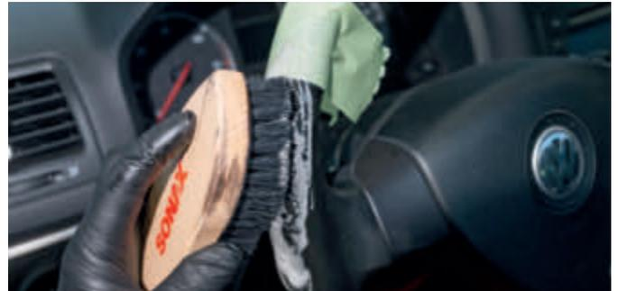
**2:** Erster Schritt: Natürlich den groben Schmutz lösen. Spezielle Reiniger schaffen das, in Kombination mit einer Bürste mit weichen Borsten. Nur so kann der Dreck im Schaum gebunden werden, ohne die Oberfläche zu beleidigen. Wichtig: Nicht mit dem Mittel sparen. So viel Schaum wie möglich!
