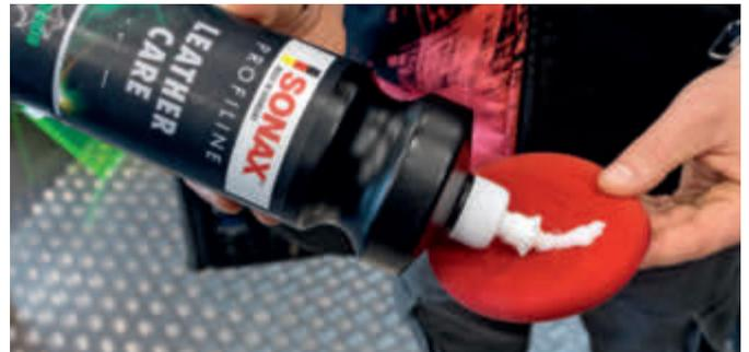
**6:** Auch wenn das Volant nun schon wie neu aussehen mag: Der nächste Schritt darf auf keinen Fall ausgelassen werden. Nach dem Abwischen ist das Leder offenporig und verletzlich. Eine schützende Schicht wirkt wie ein Balsam und verschließt die Oberfläche wieder.
