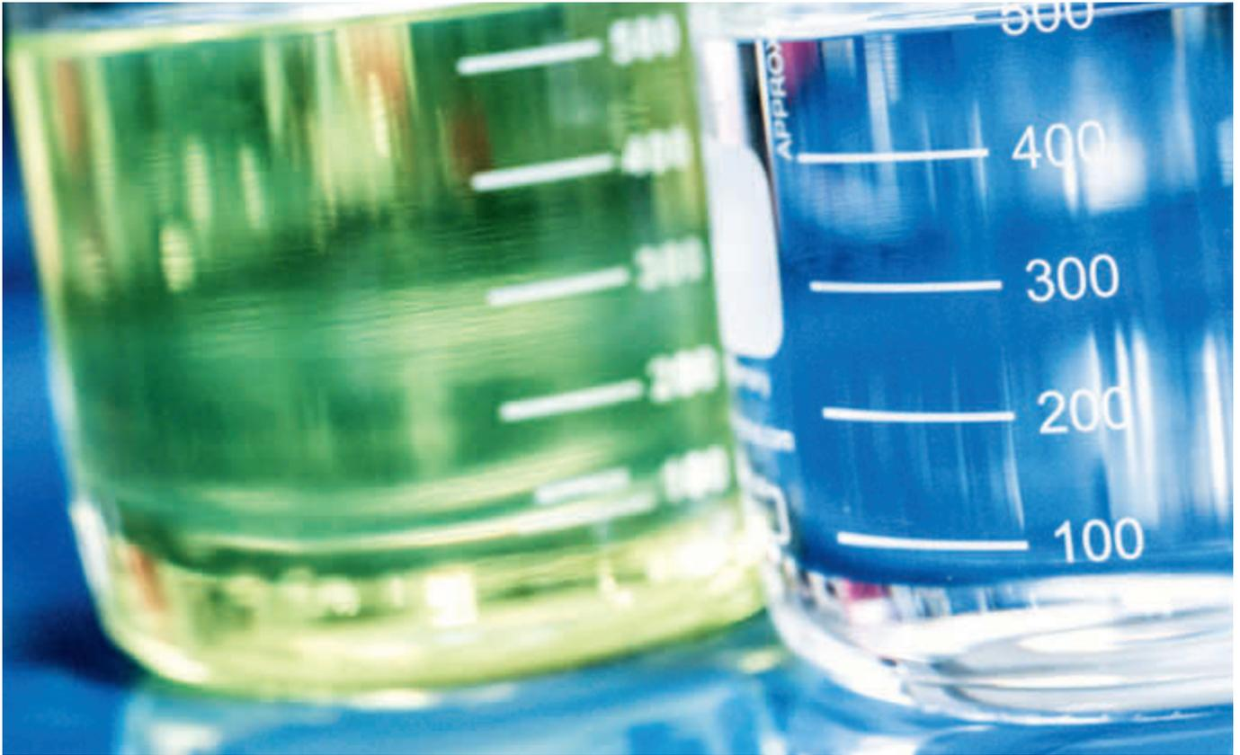
Wasserstoff, gebunden in einer durchsichtigen Trägerflüssigkeit - LOHC lässt sich deutlich einfacher handhaben als gasförmiges  $H_2$ , ist aber nicht fehlerfrei.
