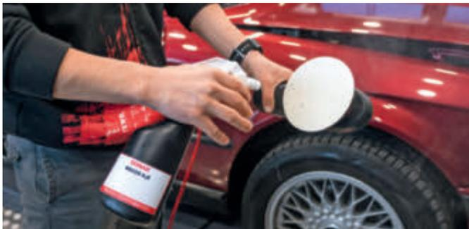
**3:** Jetzt wird es ernst. Das Scheibe gründlich trocken wischen, das Schleifpad dafür zuerst ein wenig anfeuchten. Optimal eignen sich Exemplare aus Filz, da diese die höchste Abrasivität aufweisen. Sie nehmen kein Material auf, können somit nicht verschmutzen und schleifen immer. Genau deswegen sind sie für Lacke ungeeignet.
