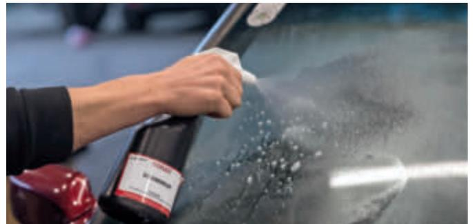
**2:** Um weitere Kratzer zu vermeiden, muss als erster Arbeitsschritt die zu behandelnde Fläche gründlich mit Scheibenreiniger und einem Mikrofasertuch gereinigt werden. Das ist insofern wichtig, da man erst im gereinigten Zustand wirklich genau erkennt, wo überall schadhafte Stellen zu behandeln sind.
