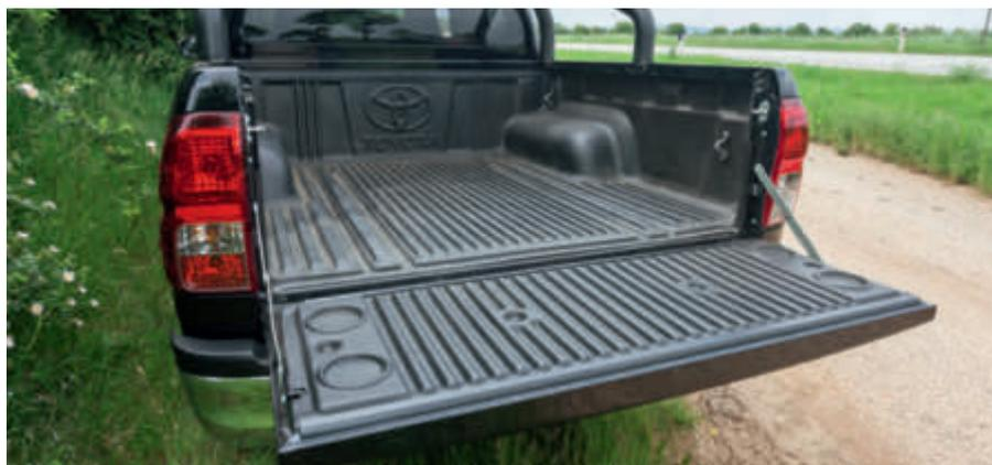
Die Ladefläche ist 1555 Millimeter lang und 1540 Millimeter breit. Und bevor die Frage auftaucht: Ja, die Scharniere sind stabil genug, damit man sich auf die Ladeklappe setzen kann.
