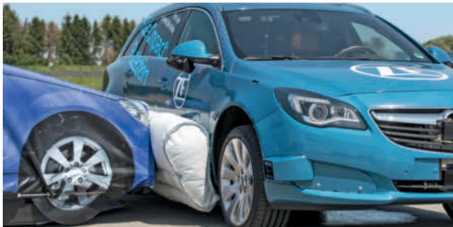
Entfaltet sich in 150 Millisekunden: Prototyp eines externen Seitenairbags von ZF.
