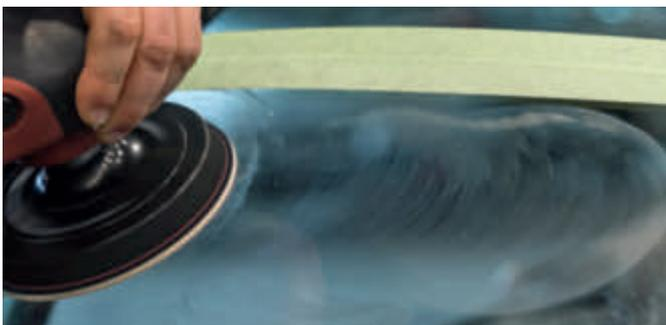
**5:** Und es kann losgehen. Die Rotationspoliermaschine auf 1000 Umdrehungen und 10 Kilogramm Druck einstellen. Wichtig hierbei: immer nur partiell vorgehen; nie versuchen, die komplette Scheibe auf einmal zu entkratzen. Dazu ist der Prozess nämlich viel zu aufwändig und man verliert sehr leicht den Überblick.
